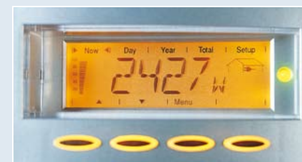
Displej Fronius Personal Display zobrazuje aktuální údaje až 15 střídačů.
