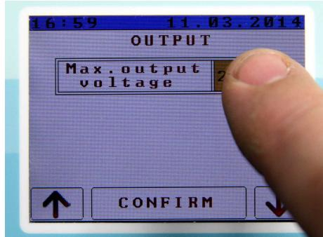
30. Durch Betätigen des Wertes im Rähmchen wird seine Änderung aktiviert und der Wert hervorgehoben.
