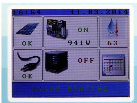
1. Solar Kerberos wird mithilfe des Touchscreens gesteuert, dessen Hauptbildschirm aus sechs Bereichen besteht. Durch ihr Betätigen (um zufälliges, mind.  $\frac{1}{2}$  Sekunden dauerndes Betätigen zu verhindern) kann man PHOTOVOLTAIC info, CONVERTER MENU, BOILER MENU, LINE supply info, UPS MENU und CALENDAR aktivieren. Zurück zum Hauptbildschirm gelangt man durch das Betätigen von "Back to main menu".
