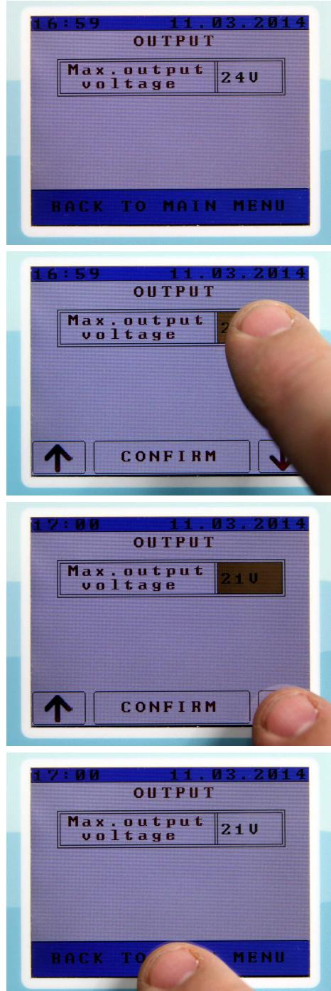
29. W Output MENU możesz nastawić napięcie ładującego wyjścia.
