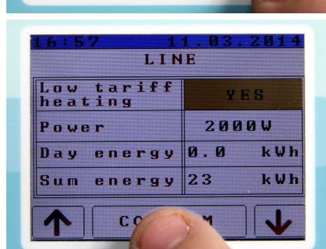
16. Stiskem ikony NO (YES) se aktivuje změna tarifu, při kterém je možno bojler ohřívat energií ze sítě. Šipkami nahoru nebo dolů se provádí změna, klávesou CONFIRM potvrzení.
