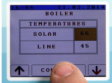
12. Nastawioną wartość potwierdź przyciskiem CONFIRM. Podczas braku czynności (30 sek.) urządzenie wraca do pierwotnego stanu.
