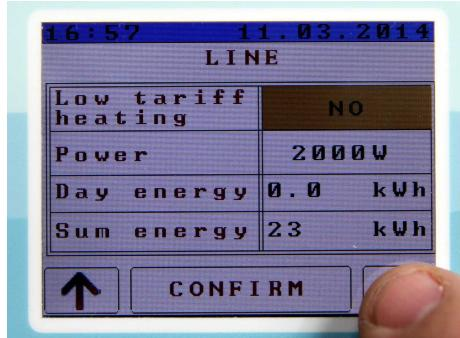
18. Mit dem Pfeil ABWÄRTS wird der Modus aktiviert, in dem der Boiler gegebenfalls jederzeit durch die Netz-Energie erwärmt wird.
