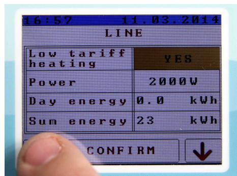
17. Przyciskiem V GÓRĘ uaktywnia się tryb, podczas którego, w razie potrzeby, bojler ogrzewa się energią z sieci tylko podczas małej taryfy - do urządzenia SOLAR KERBEROS powinno być doprowadzone również zasilanie włączane przełącznikiem czasowym do celów taryfowych.
