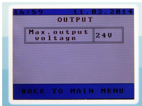
29. Im UPS MENU kann die Ausgangsspannung des Ladeausgangs eingestellt werden.
