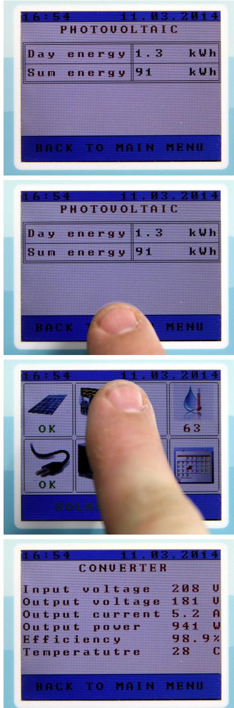
3. Der PHOTOVOLTAIC-Bildschirm zeigt die Daten über den von FV-Modulen erzeugten Strom an: die Erzeugung pro Tag und die Gesamterzeugung.
