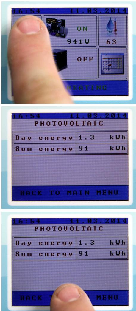
2. Stiskem ikony solárního panelu se otevře obrazovka PHOTOVOLTAIC.
