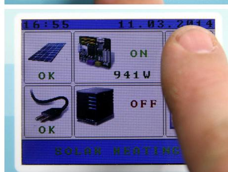
5. Stiskem ikony měniče se otevře obrazovka CONVERTER MENU.
