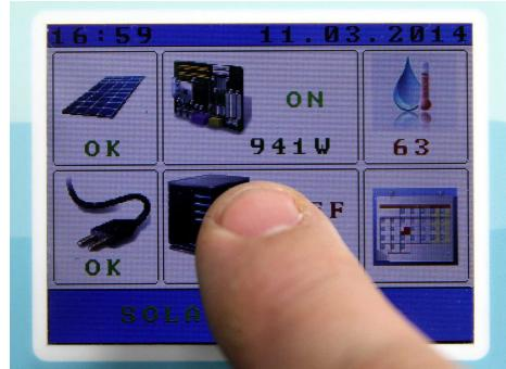
28. Stiskem ikony externího (nabíjecího) výstupu se otevře obrazovka Output MENU.
