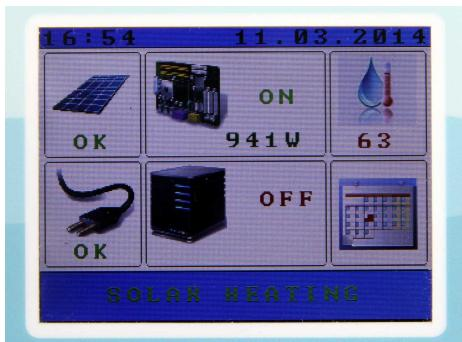
1. Solar Kerberos się obsługuje za pomocą dotykowego wyświetlacza, którego główny ekran jest rozdzielony na sześć stref. Za pomocą dotyku (aby zapobiec przypadkowym dotykom, dotyk musi trwać minimalnie 1/2 sekundy) możemy uaktywnić PHOTOVOLTAIC info, CONVERTER MENU, BOILER MENU, LINE supply info, MENU zewnętrznego/ładującego wyjścia (ma tylko wersja 250.S) i CALENDAR.
