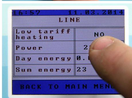
20. Durch Betätigen des Wertes am "Power" Feld werden die Einstellungen der Heizkörperleistung geändert.
