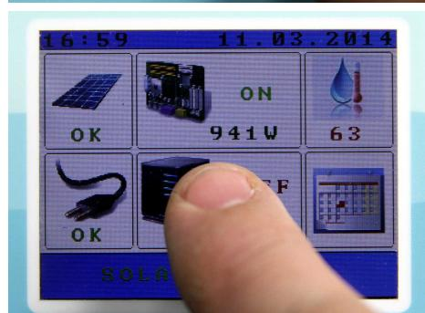
28. Przyciskiem ikony zewnętrznego (ładowującego) wyjścia otworzy się ekran Output MENU.
