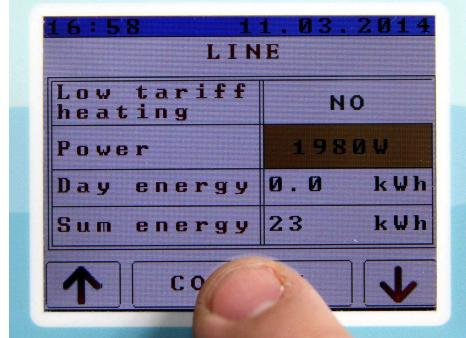
22. Nastavenou hodnotu potvrďte klávesou CONFIRM. Při delší nečinnosti (30sec.) se jednotka vrátí do původního stavu bez uložení.
