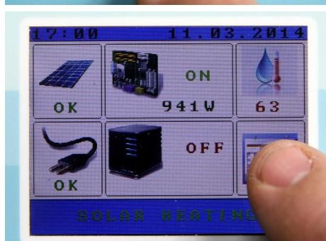
33. Durch Betätigen der Kalenderschaltfläche wird der CALENDAR-Bildschirm angezeigt.
