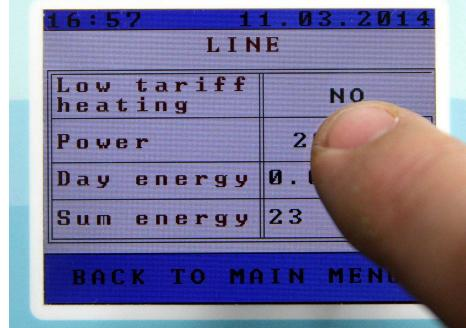
20. Zmianę ustawienia mocy elementu grzejnego uaktywniasz za pomocą dotyku wartości punktu Power.
