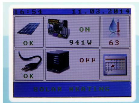
1. Solar Kerberos se ovládá pomocí dotykového displeje, jehož základní obrazovka je rozdělena na šest oblastí. Jejich stiskem (pro zamezení náhodných stisků trvajícím minimálně 1/2 sekundy) lze aktivovat PHOTOVOLTAIC info, CONVERTER MENU, BOILER MENU, LINE supply info, MENU externího/nabíjecího výstupu (jen u verze 250.S) a CALENDAR.
