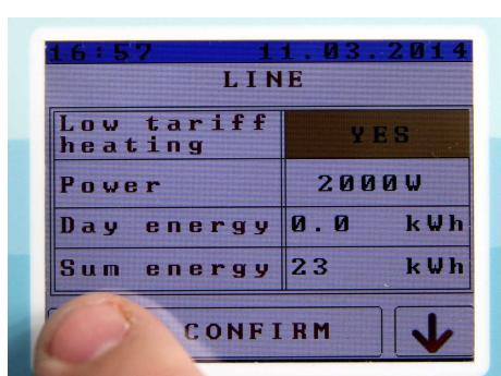
14. Durch Betätigen des Stecker-Icons wird der LINE-Bildschirm angezeigt..
