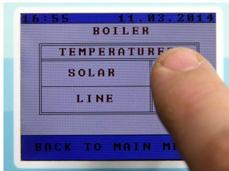
10. Za pomocą dotyku wartości w ramce możesz tą wartość zmienić. Nastawiana wartość się naświetli i pojawią się strzałki i klawisz CONFIRM. Podobnie postępujemy z wszystkimi wartościami w ramkach! (PHOTOVOLTAIC.LINE itd.)
