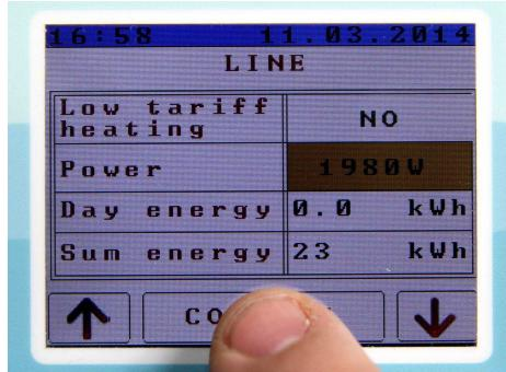
22. Bestätigen Sie den eingestellten Wert mit der CONFIRM-Taste. Bei längerer Untätigkeit (30 Sek.) geht die Einheit in den Ausgangszustand ohne Speicherungen zurück.
