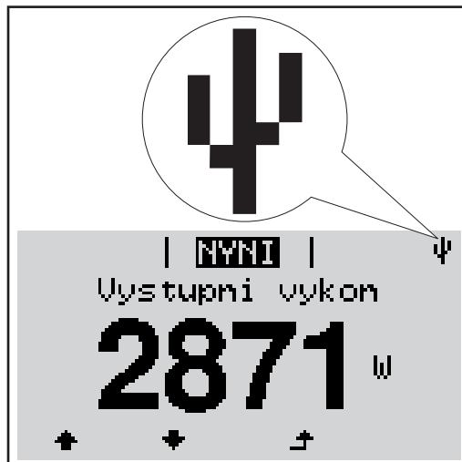
V případě, že střídač rozpozná kartu USB, zobrazí se na displeji vpravo nahoře symbol USB.
