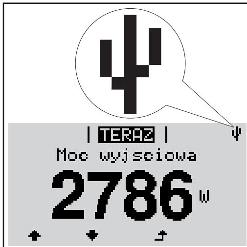
Jeżeli falownik rozpoznaje nośnik danych USB, na wyświetlaczu w prawym górnym rogu pojawi się symbol standardu USB.
